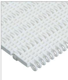
**S. 25-100** Offenes Modulband mit perforierter Oberfläche und Öffnungen (1mm) für die Drainage sehr kleiner Güter. Sehr gleichmäßiger Wasser- und Luftdurchlass bei Temperaturprozessen.
